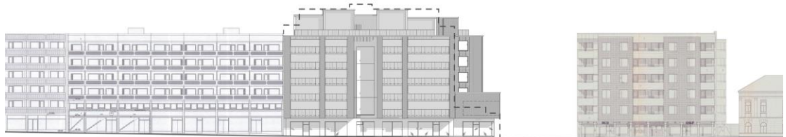
Kuva 17 Uuden kaavan mahdollistama esimerkinomainen rakennusmassa sovitettuna Porrassalmenkadun katujulkisivuun. Uuden rakennuksen räystäslinja sopeutuu 6-kerroksisiin naapurirakennuksiin, sillä ylin kerros on sisäänvedetty. Alimmissa kerroksissa naapurirakennuksen arkadikäytävä jatkuu ja
